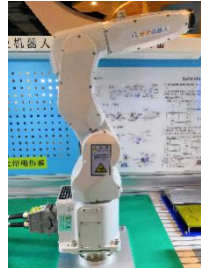
图5 6自由度工业机器人本体
